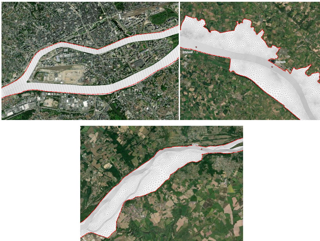
Figure 6 : Maillage de l'estuaire interne au niveau de l'île de Nantes (en haut à gauche), au niveau des zones submersibles autour de Cordemais (en haut à droite) et à l'aval du pont de Oudon (en bas)
