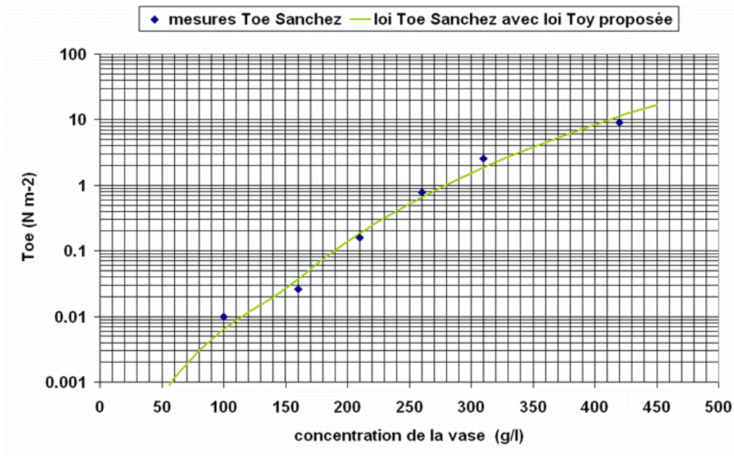
Figure 47 : Vérification des contraintes critiques d'érosion calculées avec la loi de rigidité initiale proposée
