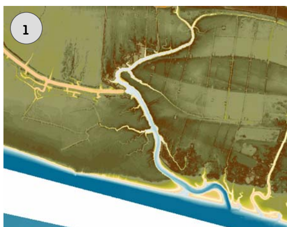
Représentation du Modèle Numérique de Terrain par scanographie laser
