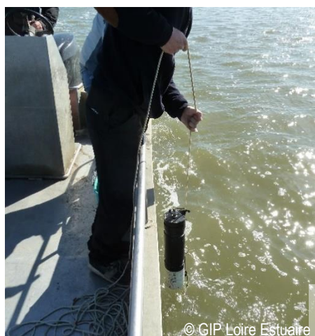
La sonde est lestée et immergée dans l'eau à l'aide d'un bout gradué.
